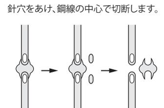
針穴をあけ、鋼線の中心で切断します。
