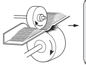
鋼線の両端を砥石で削り先を尖らせませす。
